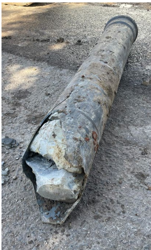
Substituição do coletor doméstico em PVCC DN200 na Avenida Eng.º José Mattos Silva em Miraflores
