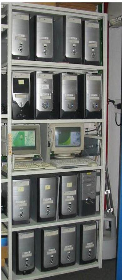
Para acelerar o processo de cálculo, é utilizado o Centro de Cálculo de Mapas de Ruído do dBLab, com 16 computadores em paralelo totalmente dedicados a calcular Mapas de ruído em processamento segmentado (Program Controlled Segmented Processing), com a licença CadnaA-Calc disponível para até 20 computadores.
